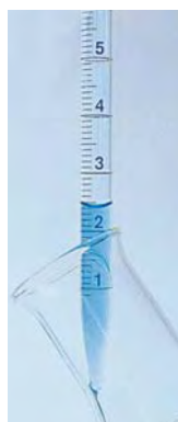
Figure 3.3 – Pour verser le liquide, la pointe de la pipette doit être en contact avec la surface en verre inclinée.
